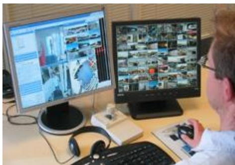
Пример вида 8x8, отправленного на **Дополнительный дисплей**. В этом примере главное окно XProtect Smart Client доступно на левом дисплее.
